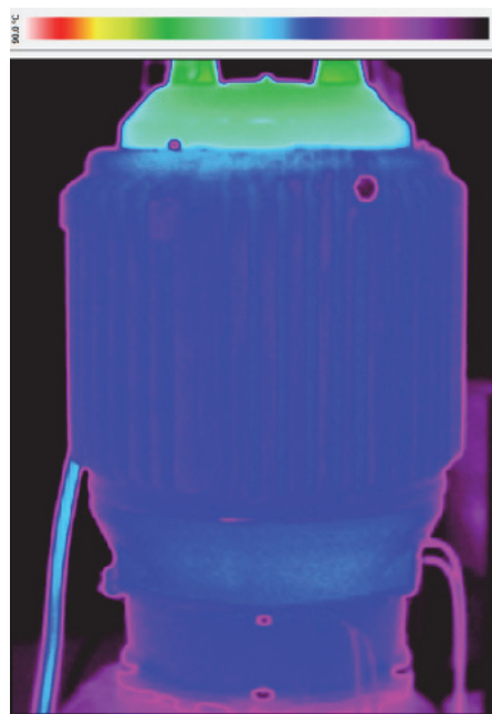
Stan cieplny silnika o mocy 55 kW po 6 godzinach pracy ciągłej w pełnym obciążeniu i w maksymalnej dopuszczalnej temperaturze pracy
